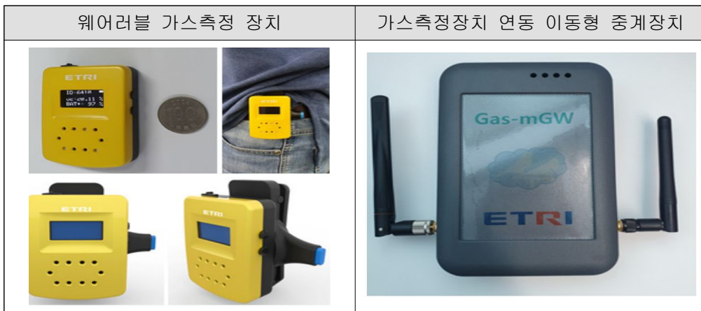
[그림 3] 재난 현장 대응 위한 웨어러블 가스측정장치와 이동형 중계장치
