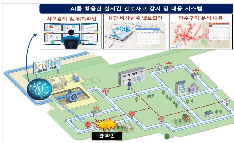
[그림 6] AI 실시간 관로 사고 감지 및 대응 시스템 (출처: 한국수자원공사)
