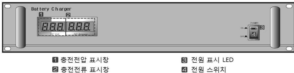
[그림 3-19] Battery Charger(예시)
