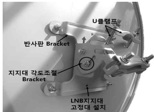
< LNB지지대 및 안테나 브래킷 설치 >
