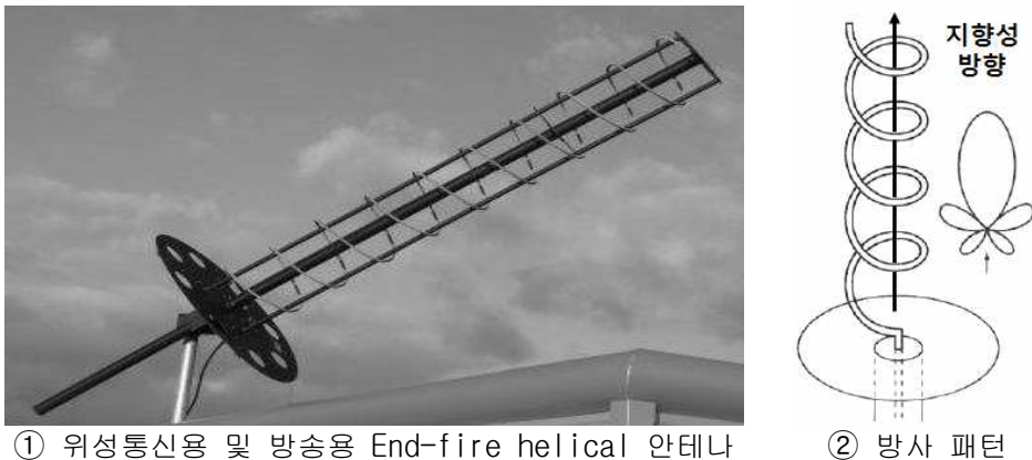
[그림 3-14] End-fire helical 안테나
