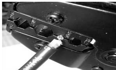
[그림 4-59] Tool용 동축 BNC 커넥터 핀 고정
