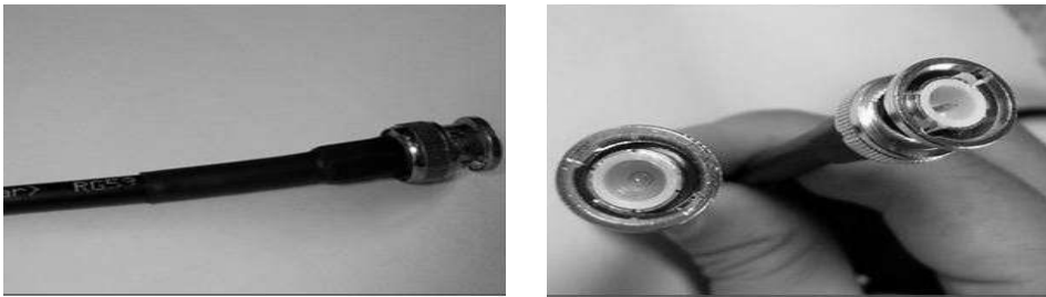
[그림 4-64] Tool용 동축 BNC 커넥터 동축선 위치 확인
