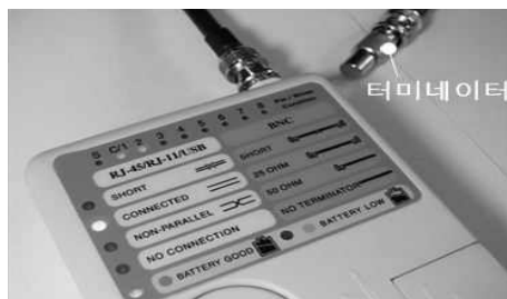
[그림 4-65] Tool용 동축 BNC 커넥터 케이블 테스트
