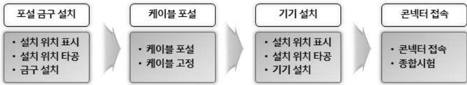
[그림 4-75] 방사형 및 누설 동축케이블 시공절차
