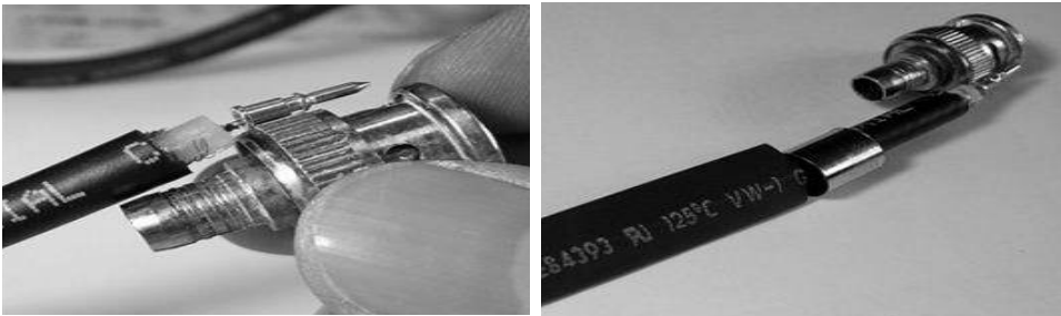
[그림 4-58] Tool용 동축 BNC 커넥터 심선 절단
