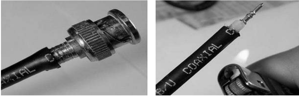
[그림 4-60] Tool용 동축 BNC 커넥터 커넥터 삽입
