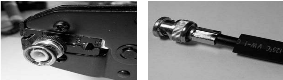
[그림 4-62] Tool용 동축 BNC 커넥터 링 고정
