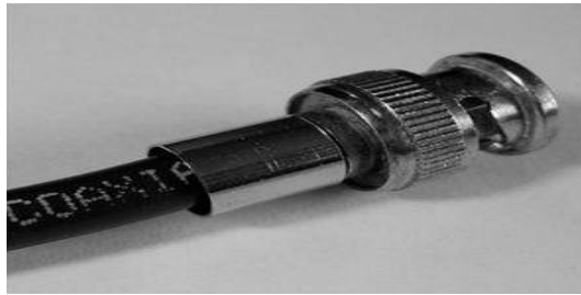
[그림 4-61] Tool용 동축 BNC 커넥터 링 정렬
