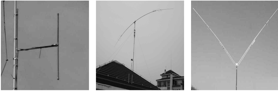
< 수직 다이폴 안테나 > < 수평 다이폴 안테나 > < V형 다이폴 안테나 >
