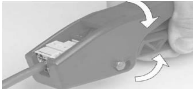
[그림 4-85] UTP Module 설치 (⑧ Tool로 고정)
