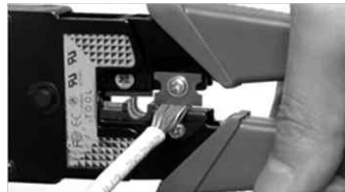
⑥ 공구(니퍼)를 사용하여 케이블 끝을 정리
