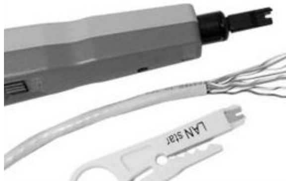
[그림 4-73] 패치패널 설치 (① 케이블 피복 제거)
