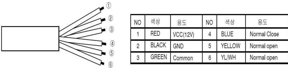
[그림 4-11] 금고 감지기 배선연결(예시)
