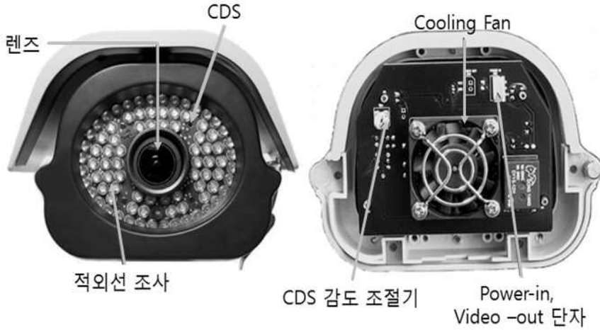
[그림 3-12] 옥외용 내부 구조(예시)
