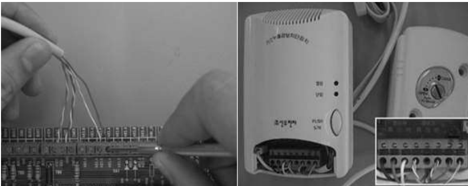
[그림 3-19] 가스밸브 컨트롤러 및 구동기 결선 예시
