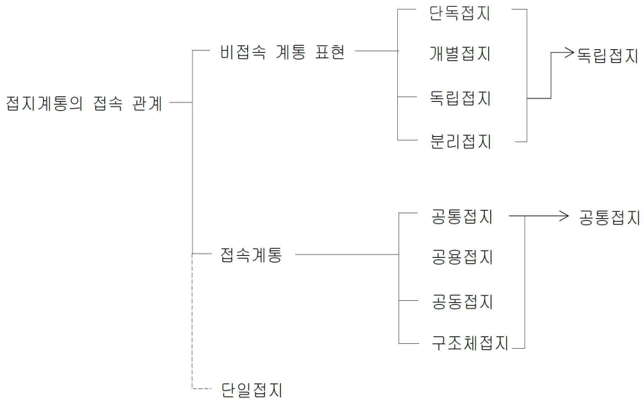
[그림 3-14] 접지계통 접속에 관한 사용 용어 분류
