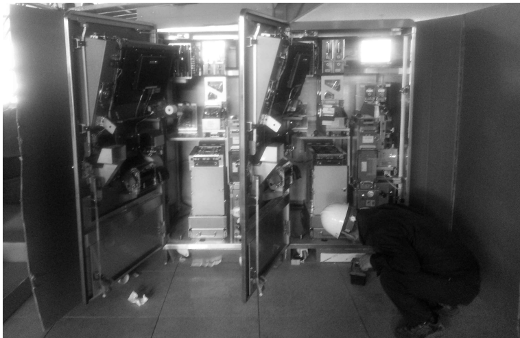
[그림 4-57] 자동정산기 전원 연결 및 접지 확인
