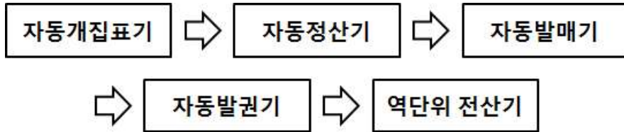
[그림 4-45] 역무자동화설비 시공 순서도<예시>
