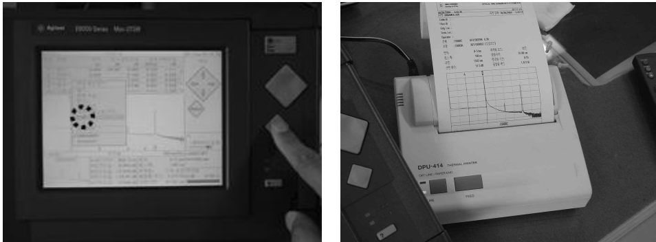
[그림 5-16] OTDR 사용법(X) 결과값 프린트
