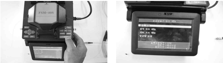
[그림 4-90] 시작 SET 스위치 누름 및 광섬유 단면의 간격이 조정됨
