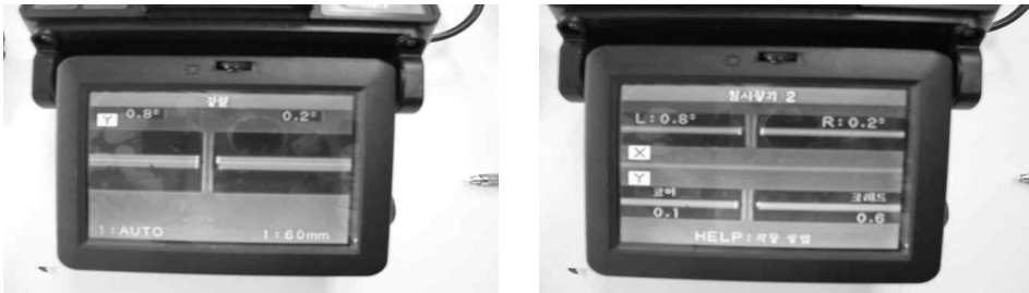
[그림 4-93] 광섬유 접속 상태 정렬
