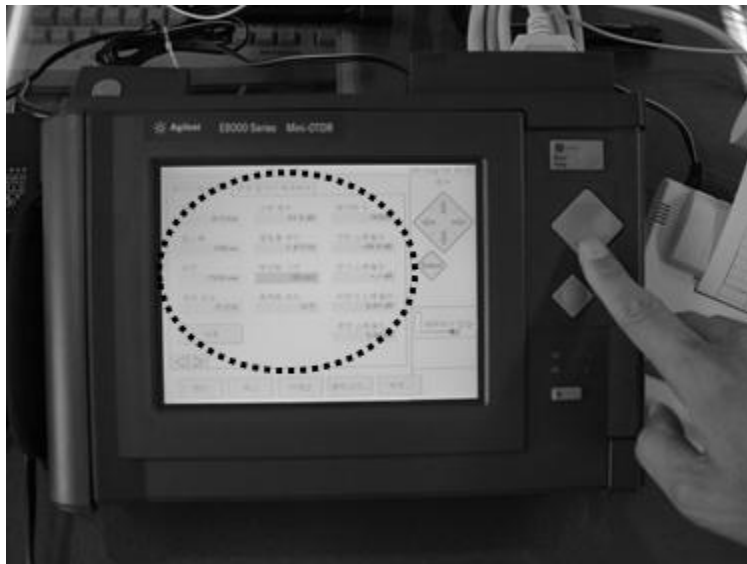
[그림 5-10] OTDR 사용법(IV) 측정조건 설정
