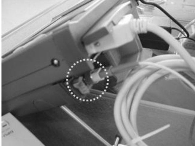
[그림 5-7] OTDR 사용법(Ⅰ) OTDR과 광케이블 연결
