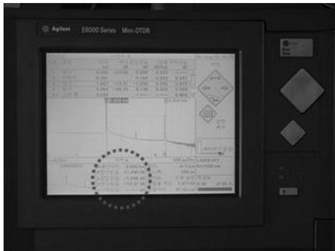
[그림 5-14] OTDR 사용법(VIII) 거리, 손실 등 확인
