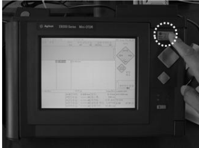
[그림 5-11] OTDR 사용법(V) Run/Stop 버튼을 누름
