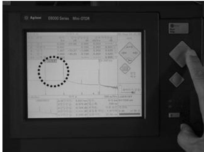
[그림 5-13] OTDR 사용법(VII) 이벤트 발생지점으로 마커 이동
