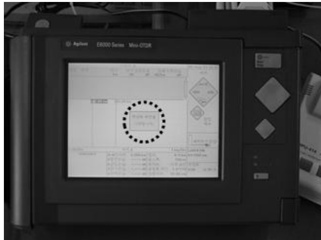
[그림 5-12] OTDR 사용법(VI) 평균화 측정시작
