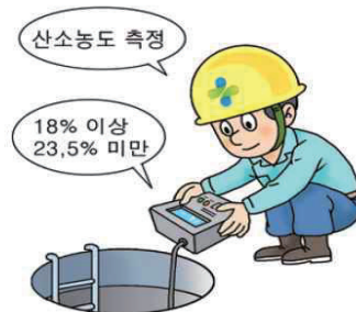
[그림 3-5] 산소 및 유해가스 농도 측정 기기 및 방법(예시)
