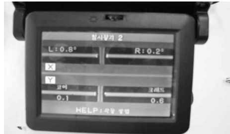
[그림 4-41] 용착접속 (⑥ 광섬유 접속 상태 정렬)
