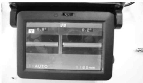
[그림 4-41] 용착접속 (⑥ 광섬유 접속 상태 정렬)
