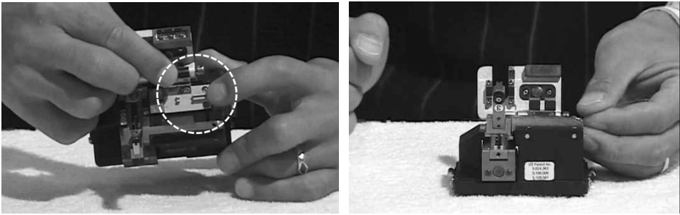
[그림 4-32] 반자동 절단기를 이용한 심선절단 (③ 가이드에 심선 정렬)
