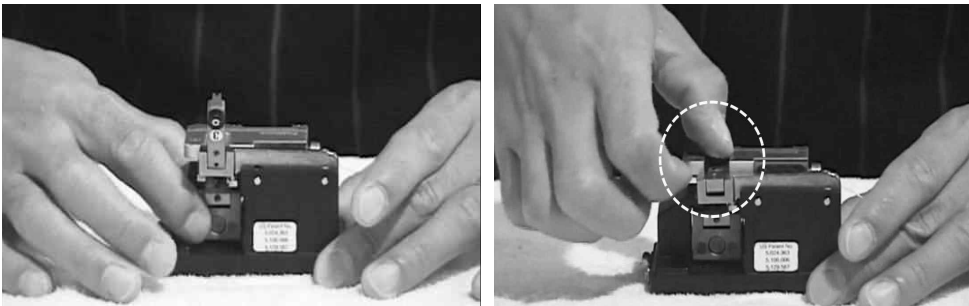
[그림 4-33] 반자동 절단기를 이용한 심선절단 (④ 심선에 힘을 줌)
