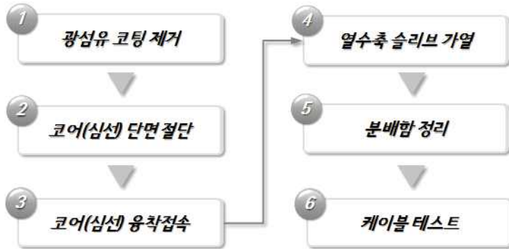
[그림 4-25] 광케이블 접속작업 Flow
