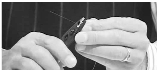
[그림 4-26] 수동 절단기를 이용한 심선절단 (① 광섬유 코팅 제거)
