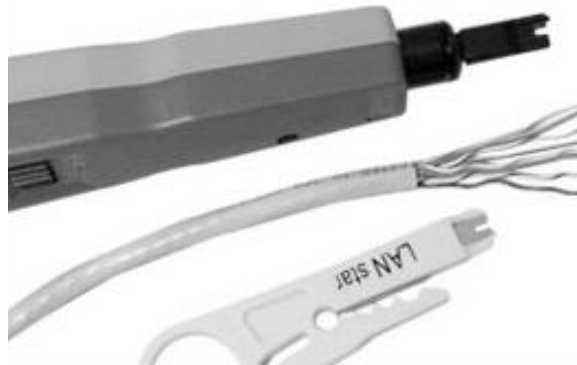
[그림 4-56] 패치판넬 설치 (① 케이블 피복 제거)
