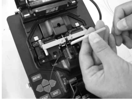
[그림 4-45] 용착접속 (⑩ 열수축 슬리브 보강상태 확인)
