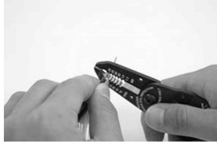
[그림 4-44] 현장커넥터 접속(② 버퍼(900 \mu m) 탈피)
