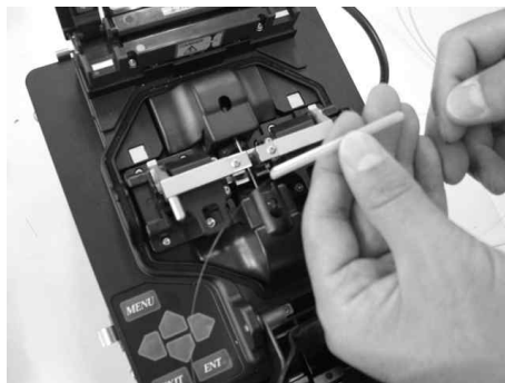
[그림 4-29] 용착접속 (⑩ 열수축 슬리브 보강상태 확인)
