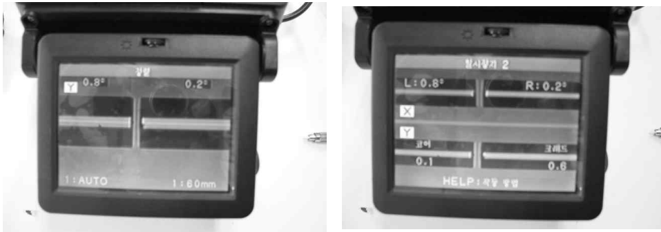
[그림 4-25] 용착접속 (⑥ 광섬유 접속 상태 정렬)
