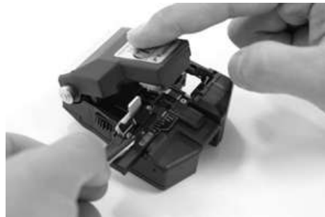
[그림 4-46] 현장커넥터 접속(④ 광섬유 절단(10mm))
