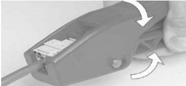
[그림 4-98] UTP Module 설치(VIII) Tool로 고정
