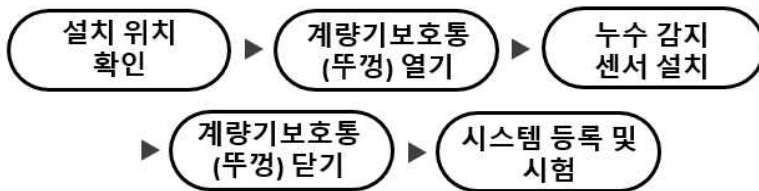
[그림 4-39] 누수 원격 관리 시스템 시공 절차(예시)
