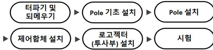
[그림 4-24] 로고젝터 시스템 시공 절차(예시)
