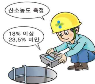
[그림 3-5] 산소 및 유해가스 농도 측정 기기 및 방법(예시)
