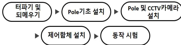
[그림 4-15] 지능형 인원계수 시스템 “폴형” 시공 절차(예시)
