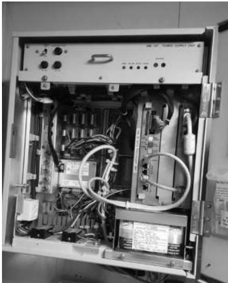
[그림 4-23] 항해기록장치 주장치 설치(예시)
