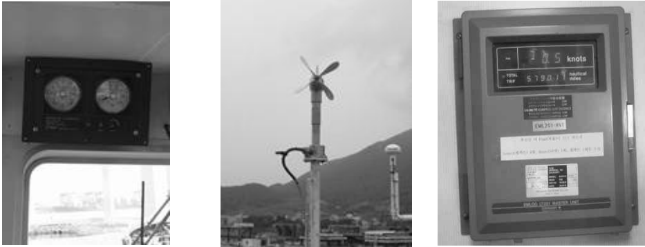
[그림 4-24] 풍속계 및 선속계 설치(예시)
