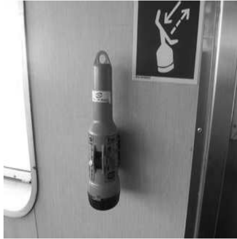
[그림 4-12] 조난구조장치(SART) 선박내 설치(예시)
