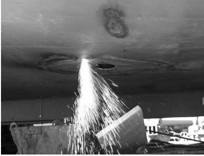
[그림 4-33] 어군탐지기 설치위치 타공(예시)
