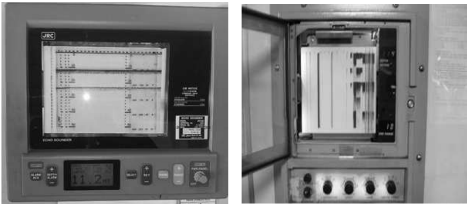
[그림 4-16] 측심기 설치(예시)
