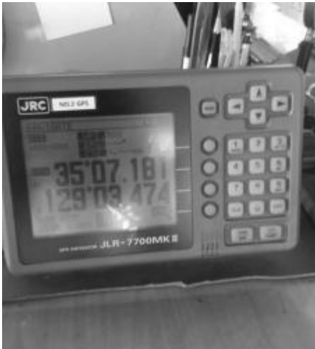
[그림 4-14] GPS 네비게이터 및 플로터 설치(예시)
