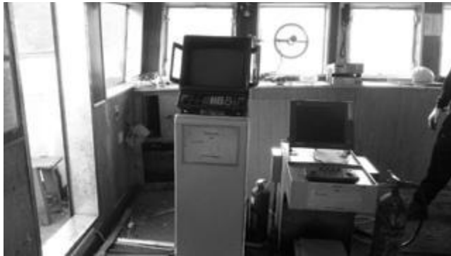
[그림 4-11] 지시기 및 전원장치(영상표시기) 설치(예시)
