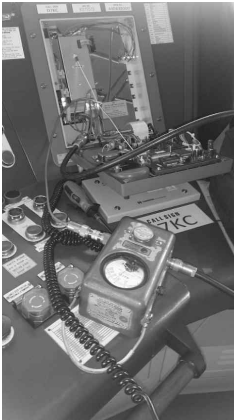
[그림 5-1] MF·HF·VHF 송·수신기 출력점검(예시)
