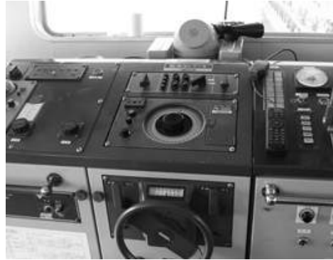
[그림 4-26] 자동조타장치 설치(예시)
