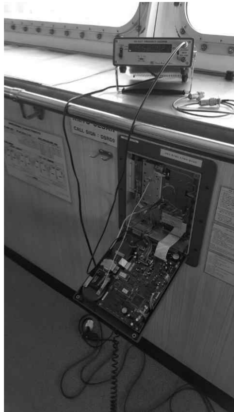
[그림 5-1] MF·HF·VHF 송·수신기 출력점검(예시)
