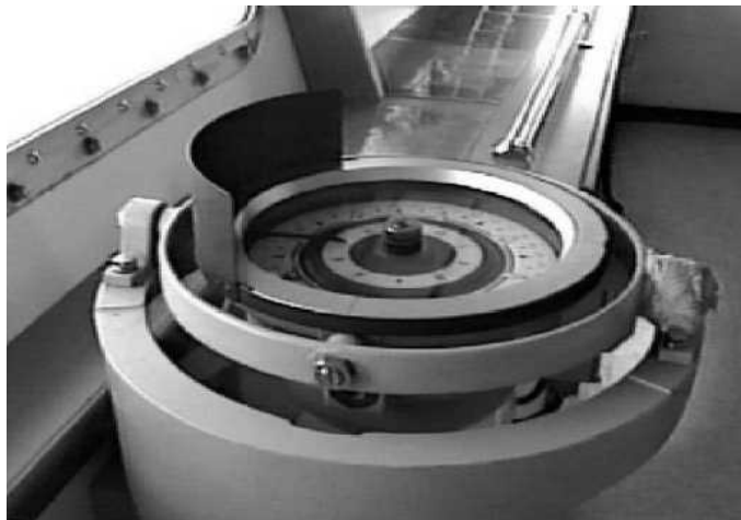
[그림 4-25] 자이로컴파스 설치(예시)
