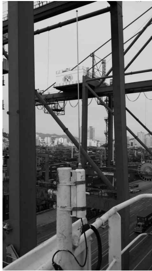
[그림 4-18] NAVTEX 안테나 설치(예시)
