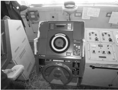
[그림 4-26] 자동조타장치 설치(예시)
