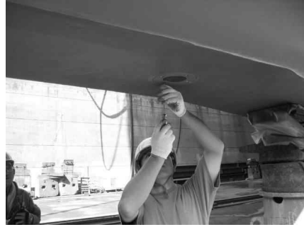
[그림 4-33] 어군탐지기 설치위치 타공(예시)
