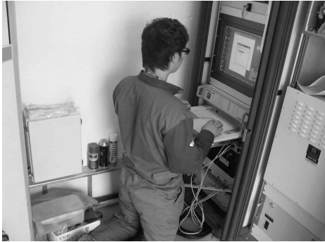
[그림 4-17] 레이더 추적장치 드라이버 및 S/W설치
