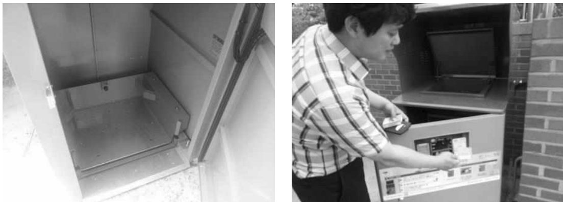
< 저울 수평조정 및 무게 측정 > < 센터 통신 및 수수료 부과 여부 확인 >
