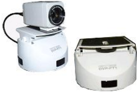
(그림 III-7) PAN/TILT 기능을 구비한 카메라
